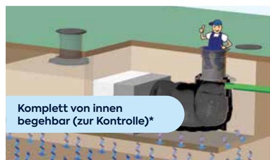
\* Versickerungsrigolen NEO 10.000 - 55.000 L sind mit zwei Schachtzugängen, 7.100 L mit einem Schachtzugang ausgestattet.
