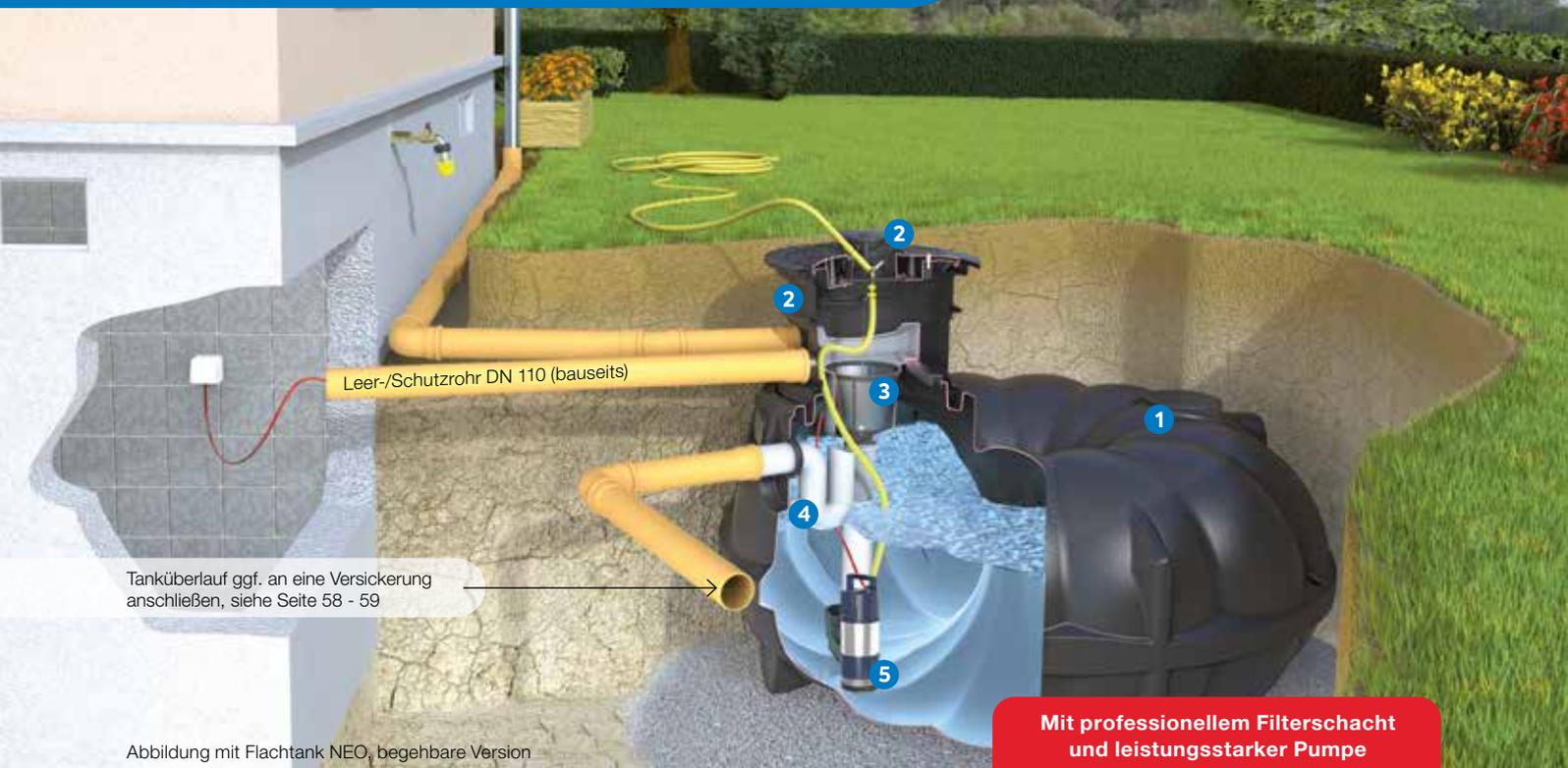
Tanküberlauf ggf. an eine Versickerung anschließen, siehe Seite 58 - 59
